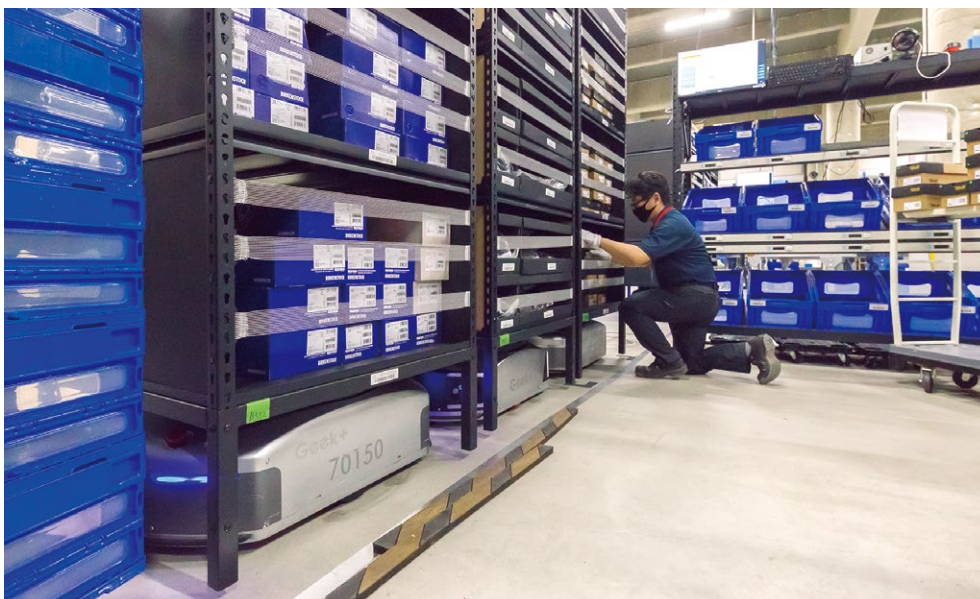
AI搭載の自動搬送ロボットは、最適ルートを走行して最適な手順で作業する。商品を保管する棚を作業員の元へ自動的に運搬するため、少ない人数でもピッキング作業を大幅に効率化できる
